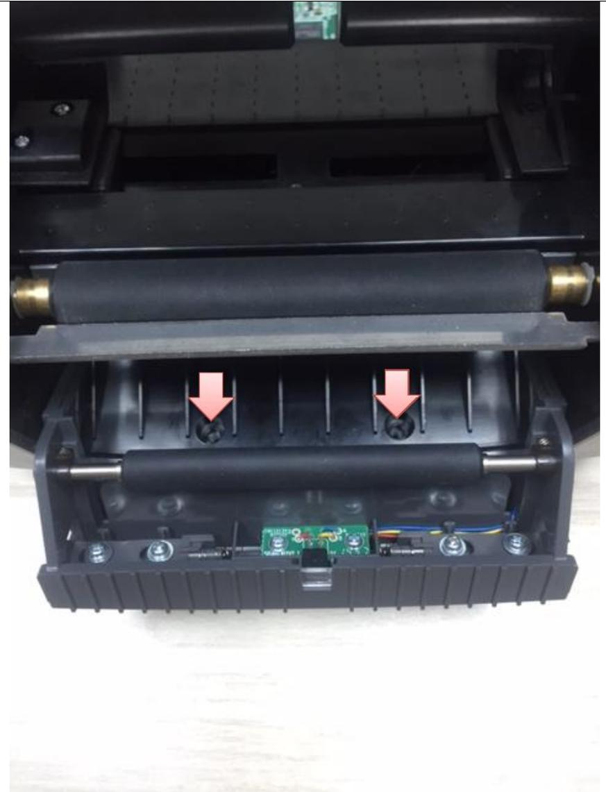
10 – Recoloque os outros dois parafusos que fixam o bloco impressor e depois encaixe a tampa superior e aperte os três parafusos.
