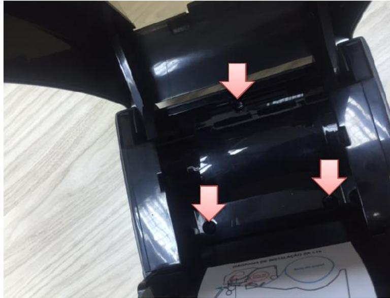
4- Deixe o mecanismo de impressão levantado, e puxe para cima a tampa superior, retirando-a completamente da impressora.
